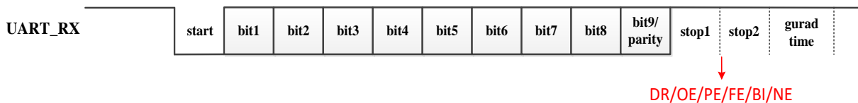
图 9-3 UART 接收器流程
